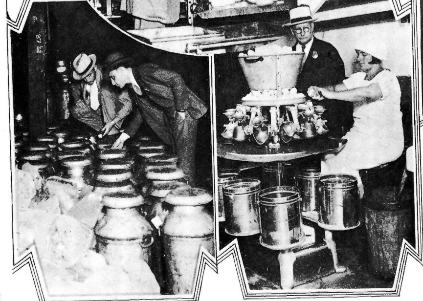
Un inspector presenciando el funcionamiento de una máquina separadora de huevos.
